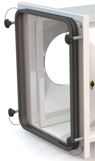
Gummiprofil med två spår, för fäste av plastpåse vid BIBO-filterbyte
